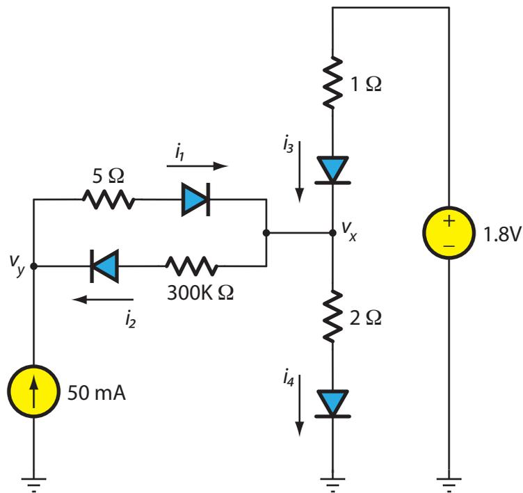
Fig. P5(a). Find  $v_x$ ,  $v_y$ ,  $i_1$ ,  $i_2$ ,  $i_3$ , and  $i_4$ .
