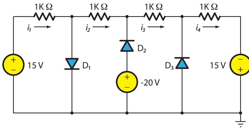
Fig. P5(a). Find  $i_1$ ,  $i_2$ ,  $i_3$ , and  $i_4$ .
