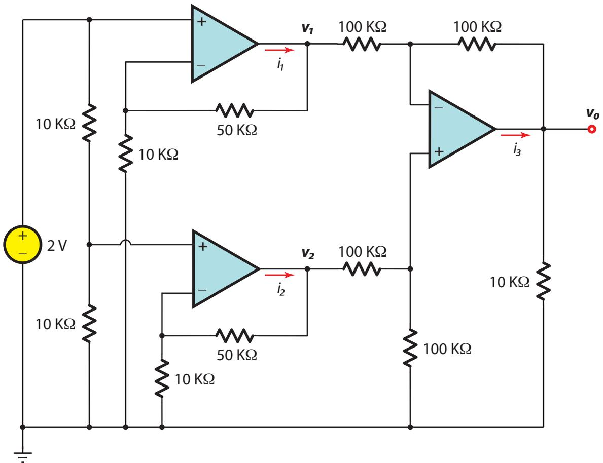
Fig. P3. Find  $v_1$ ,  $v_2$ ,  $v_0$ , then  $i_1$ ,  $i_2$ ,  $i_3$ .
