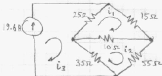
$$\text{Mesh 1: } 15i_1 + 10(i_1 - i_2) + 25(i_1 - i_3) = 0$$
